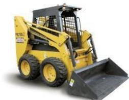
**Погрузчик с бортовым поворотом** – Мини-погрузчики с бортовым поворотом благодаря своей универсальности и возможности использовать большое количество навесных приспособлений находят множество вариантов применения в городских условиях: погрузка, транспортировка, дорожные работы, бурение, уборка дорог и тротуаров.
