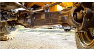
Задний мост – для обеспечения проходимости оснащен блокировкой дифференциала с электрогидравлическим управлением. Для уверенного торможения установлены надежные гидравлические мокрые тормоза, не требующие технического обслуживания.
