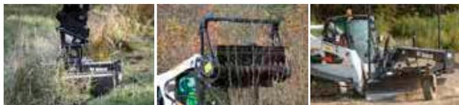
Косилка-измельчитель с автоматическим выравниванием
