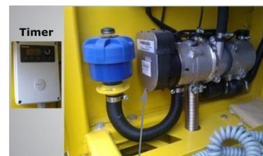
СИСТЕМА ОТОПЛЕНИЯ ДЛЯ ДВИГАТЕЛЯ
