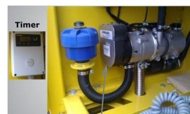
СИСТЕМА ОТОПЛЕНИЯ для ДВИГАТЕЛЯ
