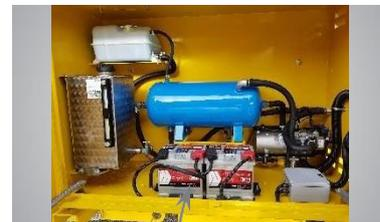
СИСТЕМА ОТОПЛЕНИЯ ДЛЯ СМАЗОЧНЫЙ БАК
