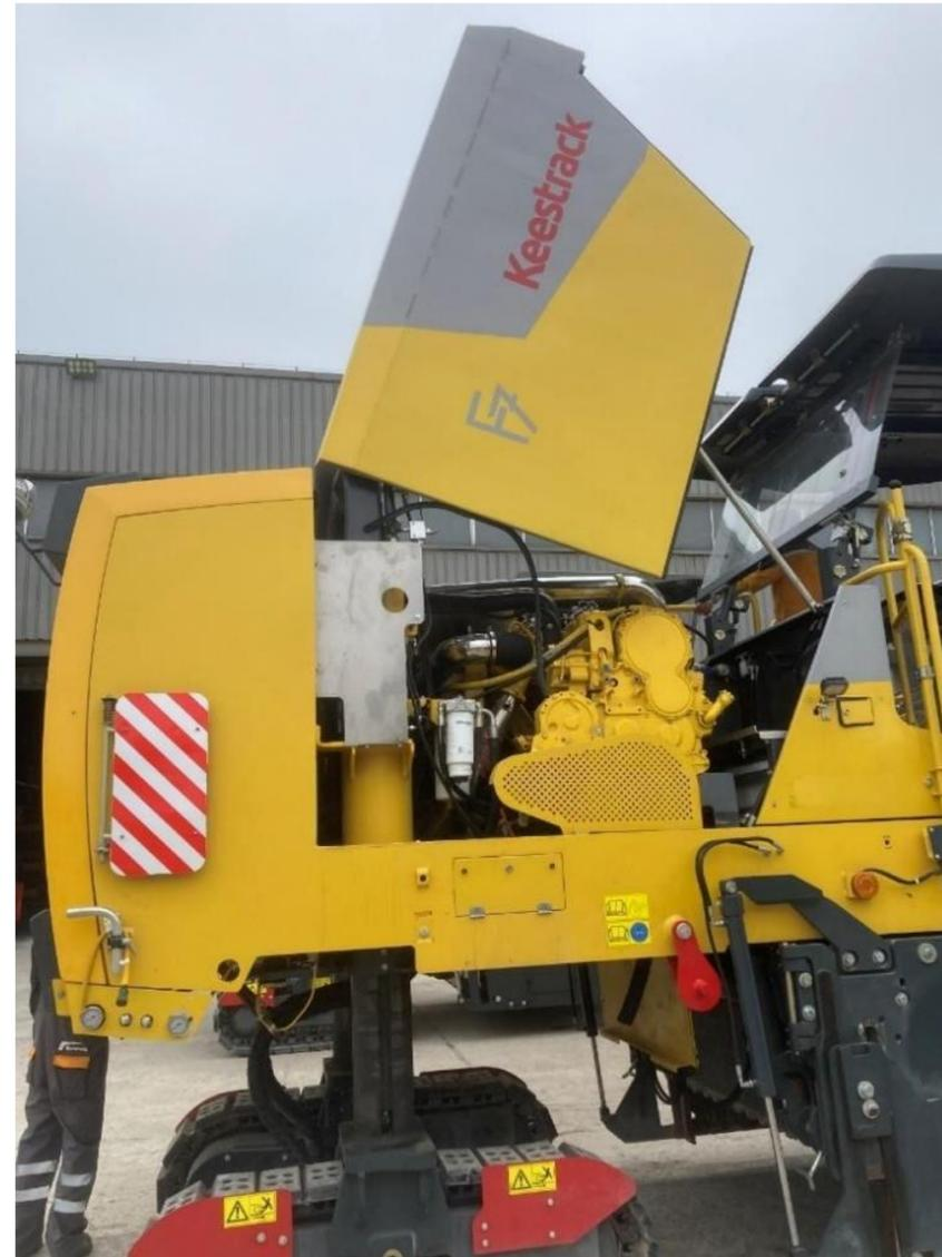
**Удобный доступ к моторному отсеку**
