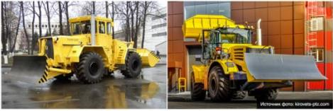
Универсальная дорожная машина К-708УДМ пришла на смену модели К-702УДМВА-УДМ2. Мощность новинки увеличили на 27,5%, производительность возросла в 1,5-2 раза. Для этого специалисты завода произвели ряд улучшений: новинку оснастили топливным баком, рассчитанным на 600 л, вдвое сократили время гидравлического цикла - до 12 секунд. К-708УДМ оснастили 8-цилиндровым V-образным дизельным силовым агрегатом ЯМЗ-238НД5 с турбонаддувом и водяным охлаждением, который выдает 300 л.с.
