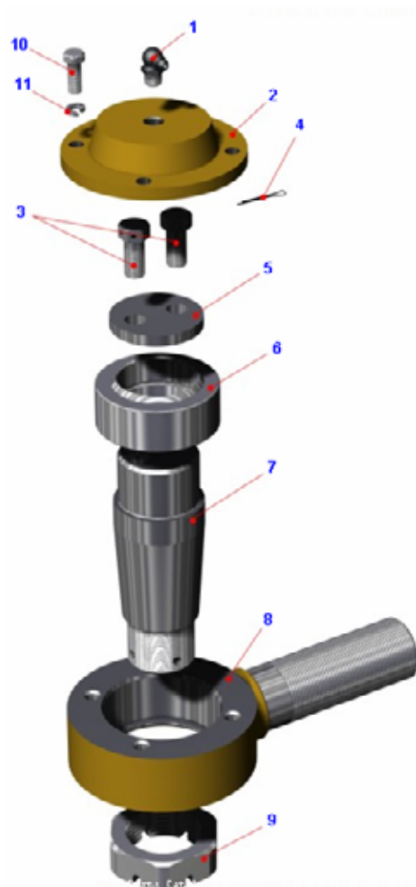
Рисунок 2.11.7 – Наконечник тяги Figure 2.11.7 – Rod end, RH
