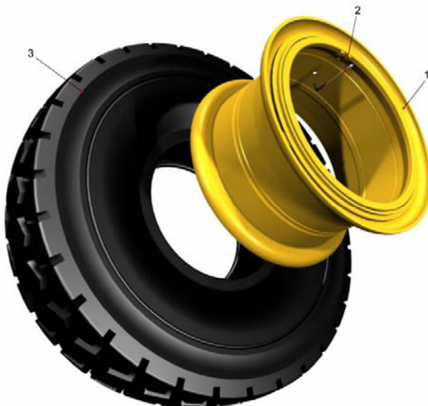
Рисунок 2.12.5 – Колесо с шиной в сборе Figure 2.12.5 – Wheel with tyre assy
