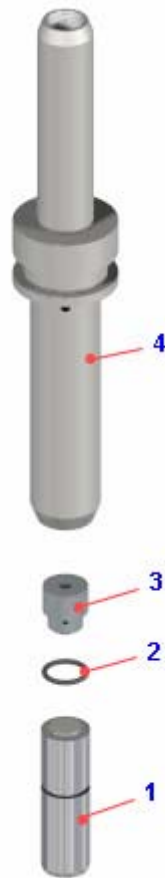
Рисунок 2.10.7 – Плунжер Figure 2.10.7 – Pump plunger
