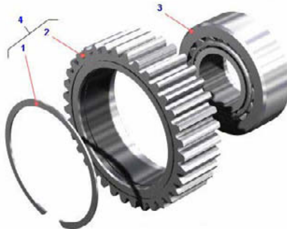
Рисунок 2.8.19 – Сателлит планетарной передачи Figure 2.8.19 – Planetary pinion
