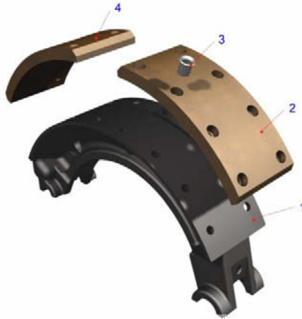
Рисунок 2.8.21 – Колодка стояночного тормоза Figure 2.8.21 – Brake shoe with lining
