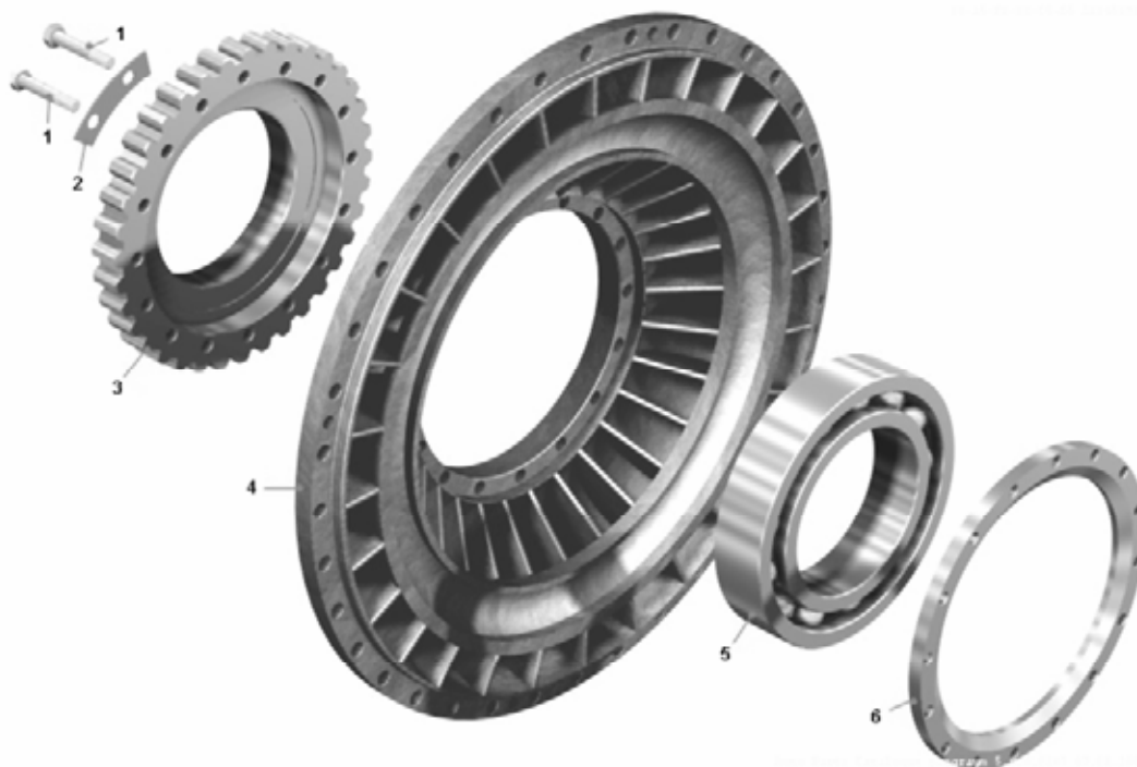
Рисунок 2.6.21 – Колесо насоса в сборе Figure 2.6.21 – Wheel pump, assy
