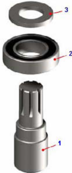
Рисунок 2.13.8 – Вал рулевого механизма Figure 2.13.8 – Steering mechanism shaft
