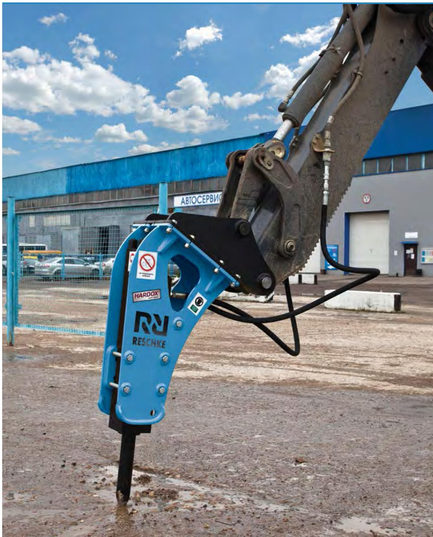
Гидромолоты средней серии нашли свое применение при строительстве и демонтаже опор мостов, сносе строений при больших объемах работ. Гидромолоты средней серии снабжены гидропневматическими мембранными аккумуляторами, которые позволяют повысить эффективность работы, сгладить воздействие на базовую машину. В средней серии гидромолотов Reschke возможна регулировка энергии и частоты ударов гидравлического молота.
