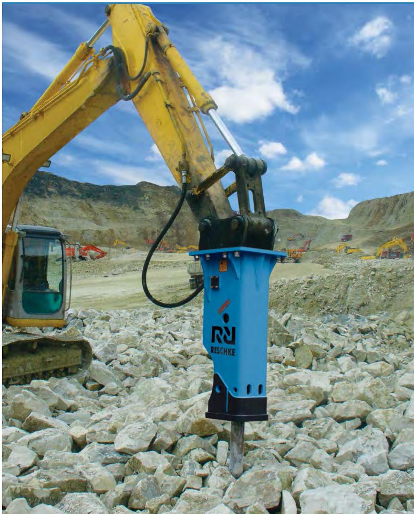
Гидромолоты тяжелой серии применяются для профессионального дробления при разработке карьеров и рудников, содержащих гранитные, базальтовые и другие высокопрочные материалы. Гидромолоты тяжелой серии снабжены гидропневматическими мембранными аккумуляторами, которые позволяют повысить эффективность работы и сгладить воздействие на базовую машину. В гидромолотах Reschke возможна регулировка энергии и частоты ударов.
